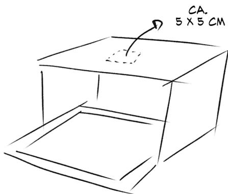
Du brauchst noch eine **Öffnung auf der Oberseite** des Kartons. Darauf legst du später dein Handy oder Tablet (oder eine andere Kamera). Achte darauf, dass die Öffnung mittig für die Kameralinse ist.
