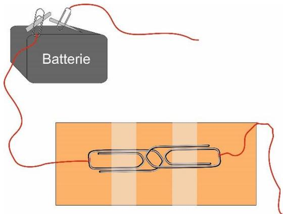
Nun ist dein Morseapparat schon fertig. Wenn du die gebogene Büroklammer herunterdrückst, sollte dein Lämpchen leuchten. Aber wie funktioniert das?
