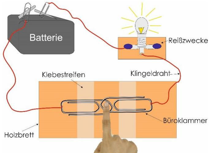
Zuerst verbindest du eine Büroklammer mit einem Stück Klingeldraht. Du kannst dir auf dem Foto abgucken, wie genau es aussehen soll. Davon benötigen wir zwei, deshalb machst du das gleich noch einmal.
