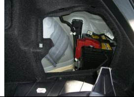
Die Fahrzeugbatterie befindet sich hinten rechts im Kofferraum. Es handelt sich um eine herkömmliche 12 Volt-Batterie.
