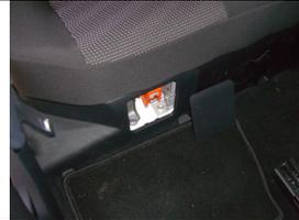
Der Wartungsstecker (Hauptschalter) befindet sich hinten rechts im Fußraum hinter einer Abdeckung aus Kunststoff. Die Hochvoltbatterie (201,6 V Gleichspannung) ist unter der Rücksitzbank angebracht.
