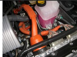
Alle Hochvoltleitungen sind mit der Signalfarbe Orange gekennzeichnet. Sie sind besonders isoliert und unterscheiden sich vom herkömmlichen 12-Volt-Bordnetz.
