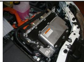
Der Inverter ist in Fahrtrichtung vorne links im Motorraum verbaut. Ein Gefahrenhinweis „Achtung Hochspannung“ ist auf der Abdeckung zu erkennen.
