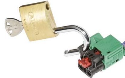
Service Disconnect mit Bügelschloss sichern
