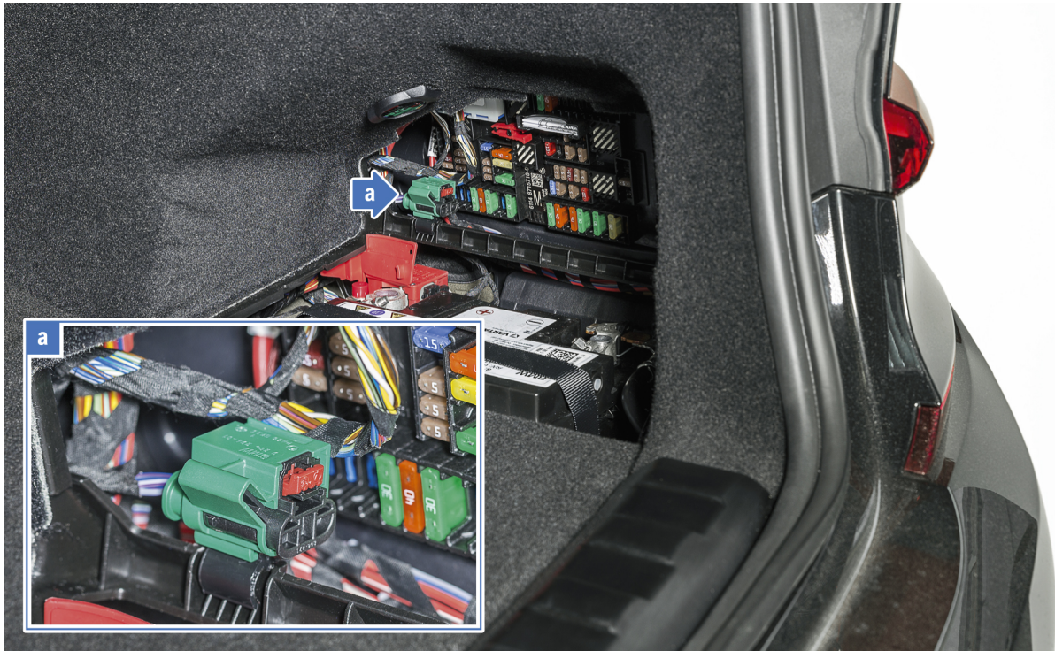
Einbauort Hochvolt-Sicherheitsstecker am G20 PHEV
