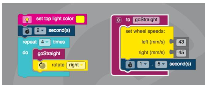
Links wurde programmiert, dass der Ozobot gelb leuchtet und nach 2 Sekunden vier Mal ausführt: Gehe geradeaus, dann Vierteldrehung nach rechts. Zu dem „GO Straight“ Befehl kommt rechts die Anweisung hinzu, dass die Radgeschwindigkeit für die beiden Räder unterschiedlich eingestellt werden.
