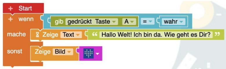
Im Vergleich von Fall C und D sollten die Lernenden erkennen, dass das Programm zerlegt wird: Wird die Taste gedrückt, so erscheint der Text. Im Fall D wird ohne Tastendruck ausschließlich der hintere Teil des Programms dargestellt. Wir sprechen von **Entscheidungen**. Das Problem: Das Programm wartet nicht auf eine Eingabe. Starten wir das Programm, so erscheint sofort das Herz. Nur in der Variante C kommt es zur Wartesituation.
