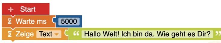
Im Fall A wird der Text erst angezeigt, wenn auf die Taste gedrückt oder etwas gewartet wird. Ansonsten passiert nichts. Anschließend läuft das restliche Programm ab. Wir haben einen **Wartebefehl** vor uns. Im Fall B wird der Text nach 5 Sekunden angezeigt.
