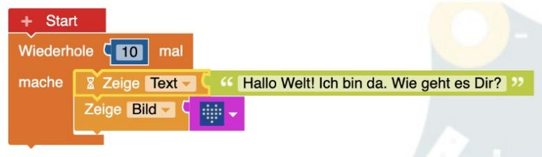
Die beiden Programme zeigen den Lernenden, dass das Programm mehrmals (bzw. dauerhaft) wiederholt wird. Es sind **Schleifen**.
