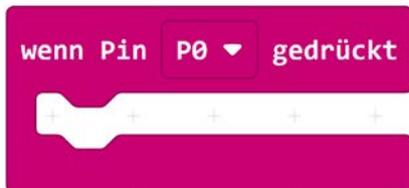
Für dieses Projekt kann der Pin P0 auf der linken Seite der Platine verwendet werden. P0 wird als gedrückt registriert, wenn der Pin mit Masse (-) verbunden ist. Nutze dies für deine Alarmanlage.
