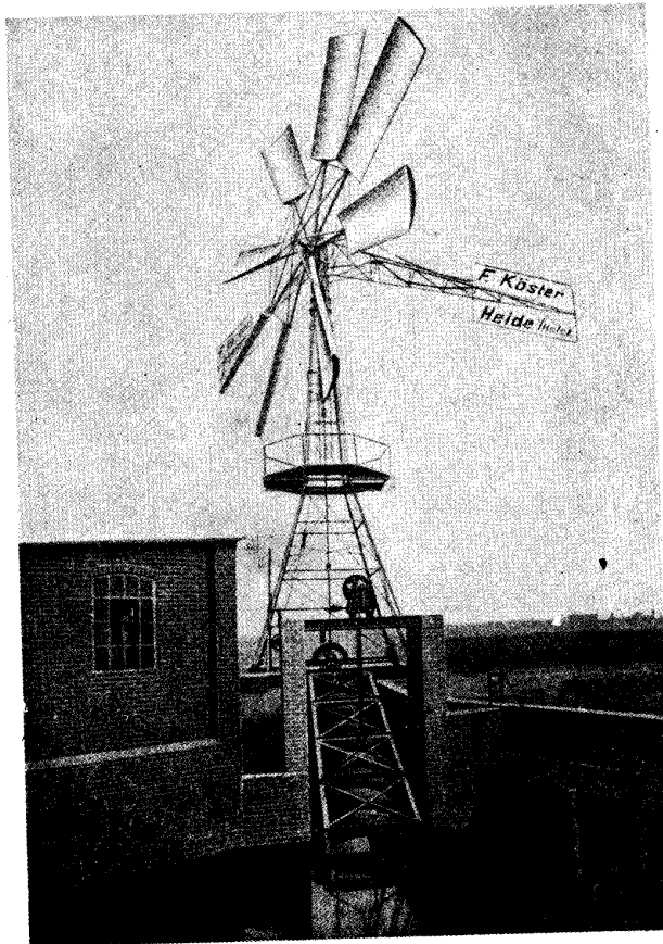
Abb. 46. Windrad von ähnlichem Typ wie Abb. 45 der gleichen Firma. Man beachte die Profilsform. Die Abb. zeigt zugleich eine der häufigsten Anwendungsgebiete: Die Anlage pumpt Wasser mittels einer Förderschnecke.
