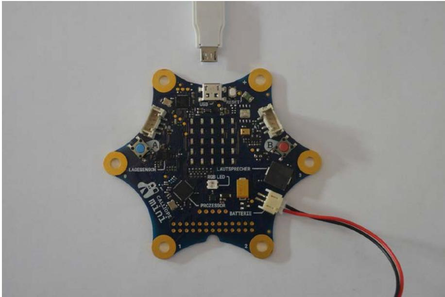
Hier musst du den kleinen Stecker des Kabels so einstecken, dass die flache Seite des Steckers nach oben zeigt:
