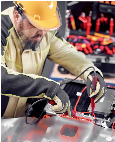
Abb. 10 Arbeiten an unter Spannung stehenden HV-Komponenten
